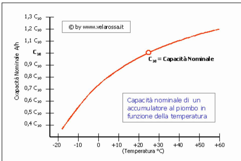
Per contro l'aumento di temperatura pur provocando un aumento della capacità nominale della batteria può essere causa di effetti negativi quali l'aumento della corrente di autoscarica, inoltre nel caso di batterie ermetiche bisogna ricordare che un aumento della temperatura richiede sempre una diminuzione della corrente di carica.
