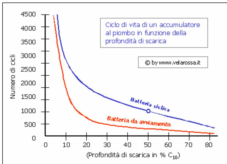
Importante quindi, in particolare per una batteria ciclica, nella fase di ricarica evitare di applicare forti correnti di ricarica che per i motivi già esposti si tradurrebbero soltanto in produzione eccessiva di gas e dissipazione di calore entrambi dannosi per la batteria stessa.
