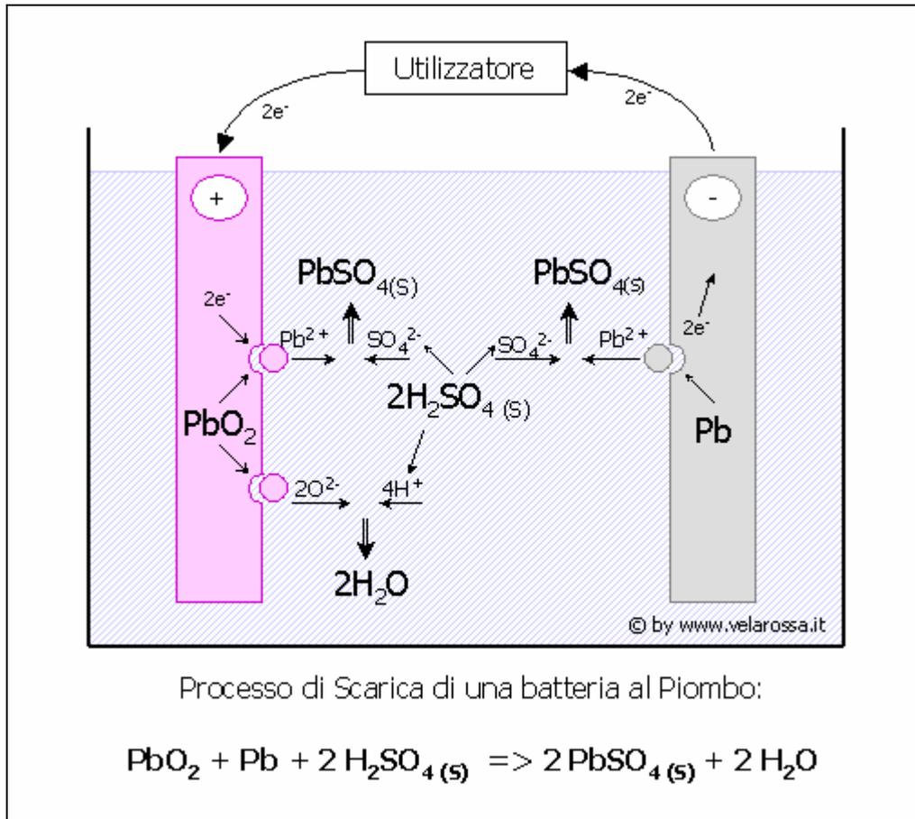
Gli ioni  $\text{Pb}^{2+}$  e  $\text{O}^{2-}$  passando in soluzione reagiscono con gli ioni  $\text{H}^+$  e  $\text{SO}_4^{2-}$  presenti nell'elettrolita formando molecole di solfato di piombo  $\text{PbSO}_4$  e acqua  $\text{H}_2\text{O}$ .
