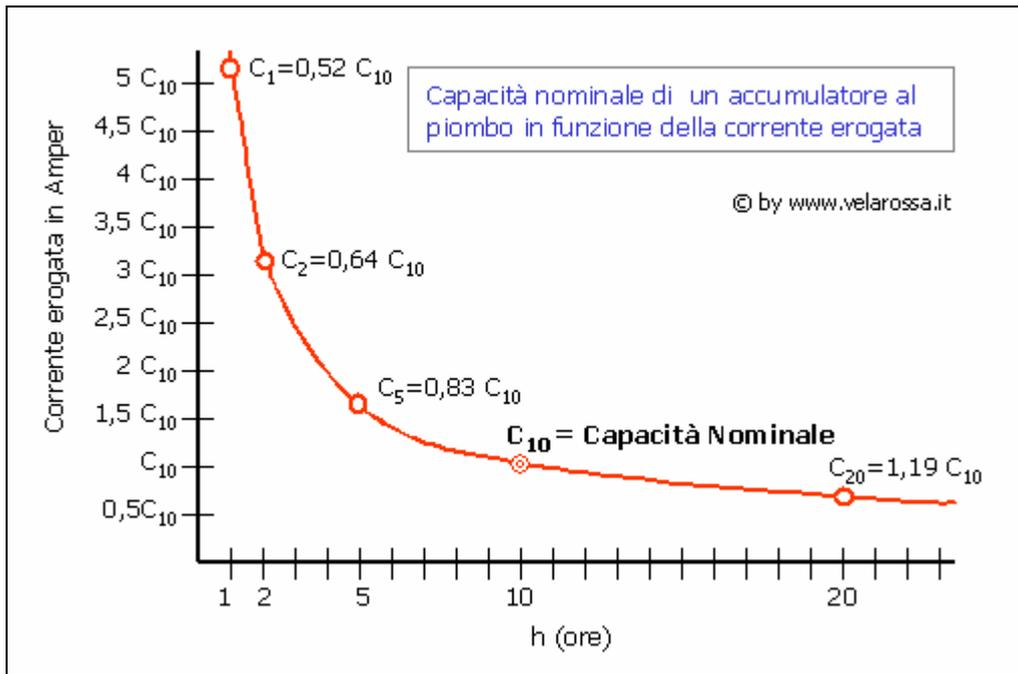
Questa differenza dipende dal fatto che una stessa batteria ha capacità diversa in funzione dell'intensità della corrente erogata (la capacità nominale diminuisce all'aumentare della corrente).
