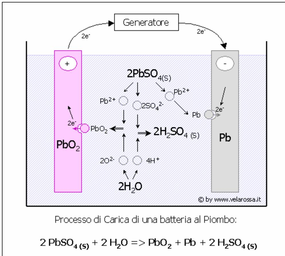
Il processo di ricarica si può considerare ultimato quando tutte le molecole del solfato di piombo ( $PbSO_4$ ) formatesi durante la scarica sono state nuovamente scomposte ripristinando l'iniziale concentrazione di acido solforico nell'elettrolita.
