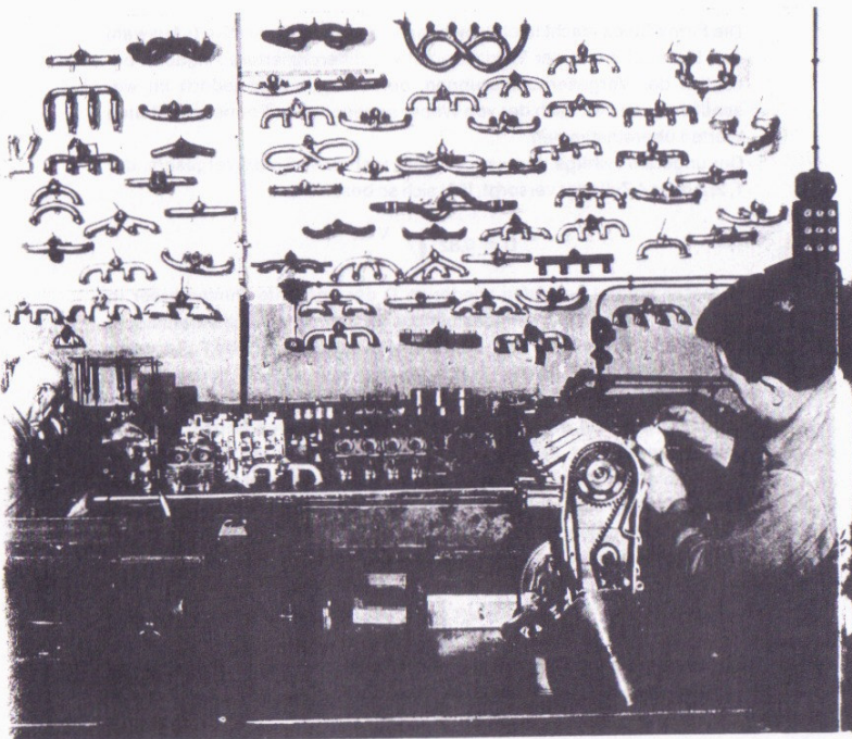
Eine optimale Saugrohrgestaltung erfordert zahlreiche Versuchsmuster.
