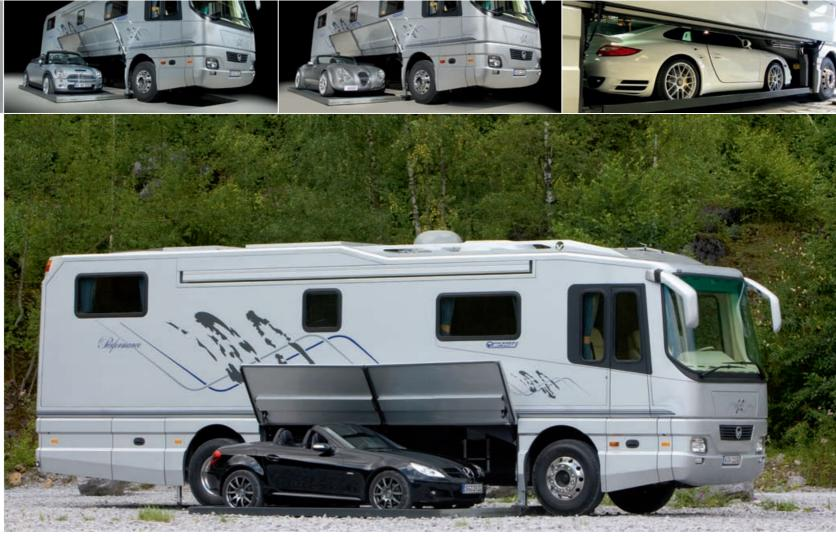
Die zukunftsweisende Konstruktion der patentierten Mittelgarage von **Volkner Mobil** macht die Mitnahme verschiedener PKW-Größen – je nach Aufbaulänge des Fahrzeugs – möglich. So findet bei der Variante mit einer Gesamtlänge von 11 Metern ein Mini Cooper Platz. Das *Performance*-Modell mit einer Gesamtlänge von 12 Metern ermöglicht sogar die Mitnahme eines Porsche 911, Jaguar XK8 Cabriolets, BMW 6er Cabriolets, Maserati Quattroporte oder ähnlich dimensionierten Pkws.
