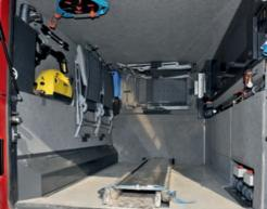
Die Garage ist für Fahrräder, einem Motorroller oder einem Quad gestaltet. Der Motorroller kann über eine drehbare Aluminium-Auffahrschiene ganz leicht aus- und eingeladen werden, das Quad zieht sich über zwei Aluminium-Auffahrschienen mittels Winde selbstständig ein. Wahlweise kann die Garage als Heck- oder Seitengarage gefertigt werden.
