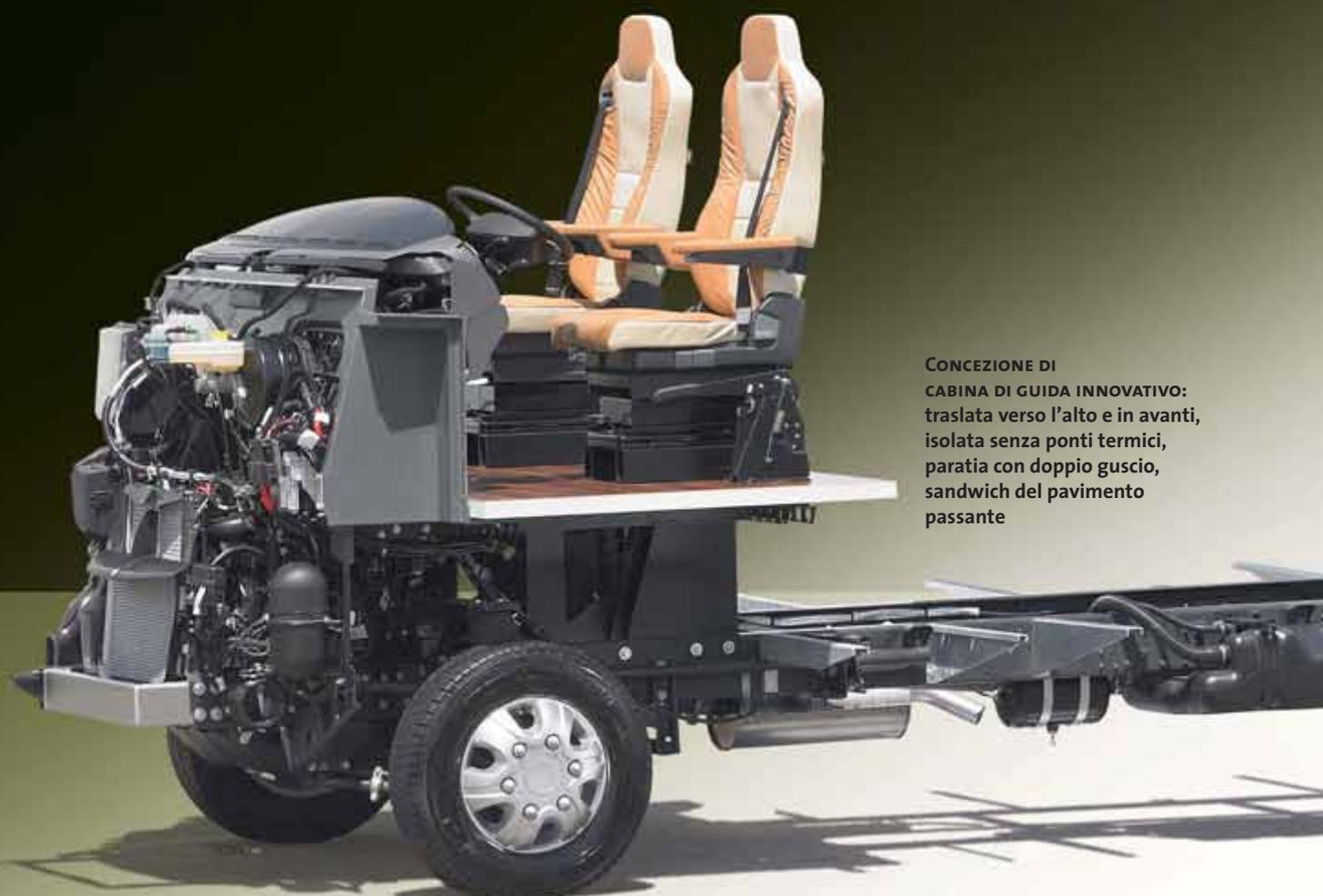
**CONCEZIONE DI CABINA DI GUIDA INNOVATIVO:** traslata verso l'alto e in avanti, isolata senza ponti termici, paratia con doppio guscio, sandwich del pavimento passante
