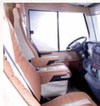
Sedili della cabina di guida confort SKA traslati verso l'esterno per un passaggio più largo in cabina di guida e un maggior confort di seduta nella posizione salotto
