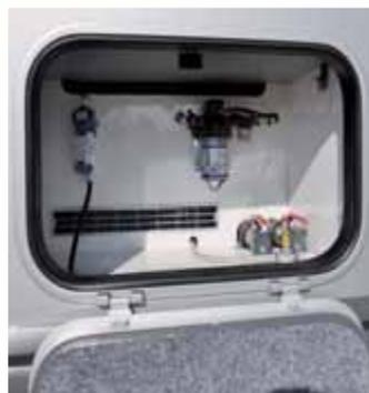
Spazio dell'impianto idrico centralizzato nel doppio pavimento al sicuro del gelo riscaldato e comodamente accessibile
