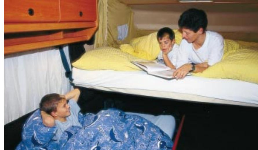
Eine traumhafte Schlafstatt ist das Hubbett. Zunächst klappen wir die Lehnen von Fahrer- und Beifahrersitz nach vorn, ziehen das Hubbett herunter und anschließend zum Wohnraum hin aus. Mit zwei Gurtschlössern sichern wir die nachgerüstete Riepert/Laika-Konstruktion und schieben noch ein beiliegendes Matratzenstück an seinen Platz. Schlafen wie zu Hause: Im umgebauten Ecovip wird es wahr. Die üppigen Maße, das Bett ist 185 Zentimeter breit und 200
