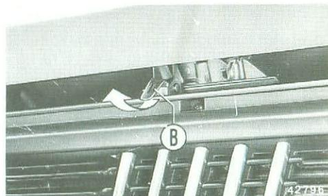
El capó totalmente abierto se sujeta con el soporte autoblocante C. Fijese que el soporte C resulte bloqueado. Para cerrarlo, levante un poco el capó y tire con la mano de la articulación del soporte C hacia el exterior.
