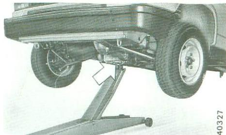
Para levantar el vehículo por la parte posterior, poner la extremidad del gato hidráulico debajo de los lados del eje rígido, **sólo con el vehículo descargado.** Para intervenciones sobre el vehículo cargado, utilizar un apropiado elevador de pasillos o bien un foso.
