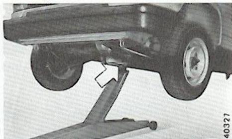
Per sollevare il veicolo dalla parte posteriore disporre l'estremità del cricco idraulico sotto ai lati dell'assale rigido, **solo a veicolo scarico.** Per interventi su veicolo carico utilizzare un adeguato sollevatore a pedane o fossa.
