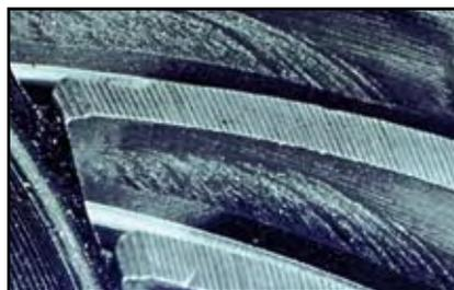
*Scuffing (usura adesiva): spostamento di metallo da un dente ad un altro dell'ingranaggio. Si sviluppa una superficie opaca.*
