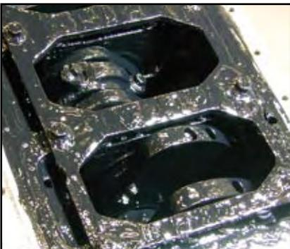
*Sludge: uso di un lubrificante non adeguato all'intervallo di cambio con conseguente esagerato inspessimento dell'olio che tende a depositarsi sulle parti-motore.*
