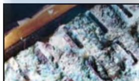
Sezione di radiatore che mostra evidenti depositi e tracce di corrosione dovuti all'utilizzo di un antigelo non idoneo.
