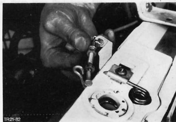
Fig. 141. Unhook hood cable
